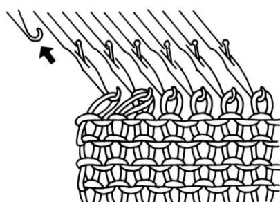
I. Двухигольным деккером перевесьте две крайние петли на соседние нагруженные петлями иглы. При использовании для вязания каждой второй иглы эта операция выполняется с помощью трехигольного деккера.
