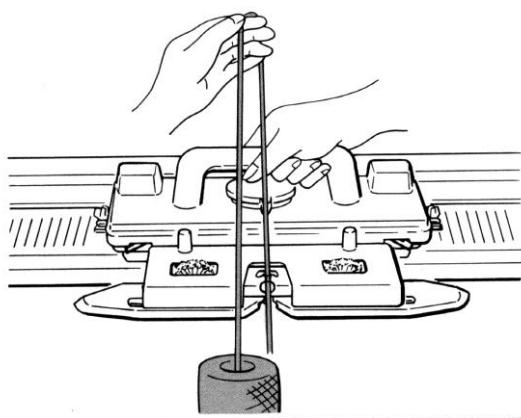
При этом плечо каретки должно миновать сепаратор нити и удалиться от него на 2 - 3 см перед началом провязывания следующего ряда. Расположение нитей относительно сепаратора при выполнении "одиночного мотива" орнамента: Фоновая нить (нитеводитель 1) – над сепаратором; Контрастная нить (нитеводитель 2) - под сепаратором Сепаратор нити должен разделять две нити в каждом ряду вязания. Если же обе нити оказались по одну сторону сепаратора, разделите их вручную.
