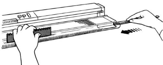
6. Верните фиксатор игл на прежнее место, надавливая на плавающие иглы ровной стороной отборной гребенки.
