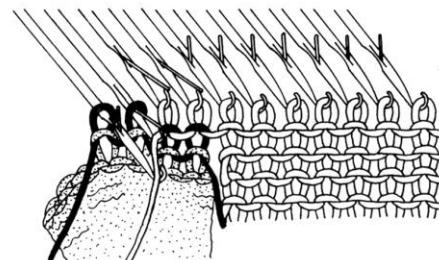
3. Опять переведите вновь включенные в работу иглы из положения "В" в "Д" и набросьте рабочую нить на крючки. Поочередно верните иглы в положение "В", провязав на них петли рабочей нитью вручную и продолжайте вязание
