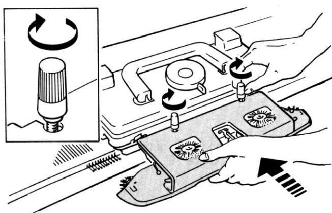
Соедините плечо с кареткой. Для этого подведите выемки на плече под гайки, прижмите плечо к каретке и закрутите гайки /по стрелке/. Убедитесь в том, что гайки точно совпадают с выемками плеча.
