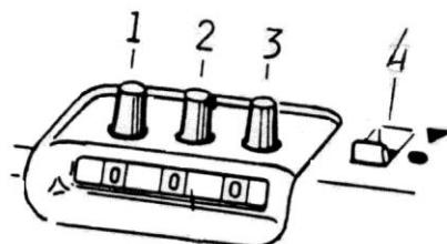
Для изменения показаний счетчика поверните установочные головки "1" "2" и "3" в любом направлении.
