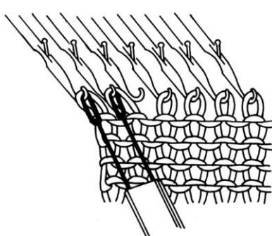
I. Выдвиньте соседнюю с рабочими иглами свободную иглу в положение "В". Двухигольным деккером сместите две крайние петли в сторону прибавляемой иглы. (При вязании каждой второй иглой эта операция выполняется трехигольным деккером).
