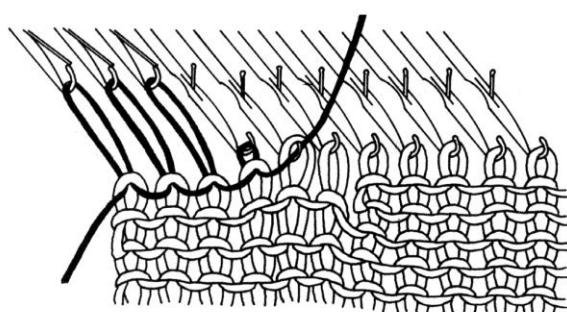
1. Выдвиньте в один прием расчетное количество игл в положение D на стороне, противоположной каретке.
