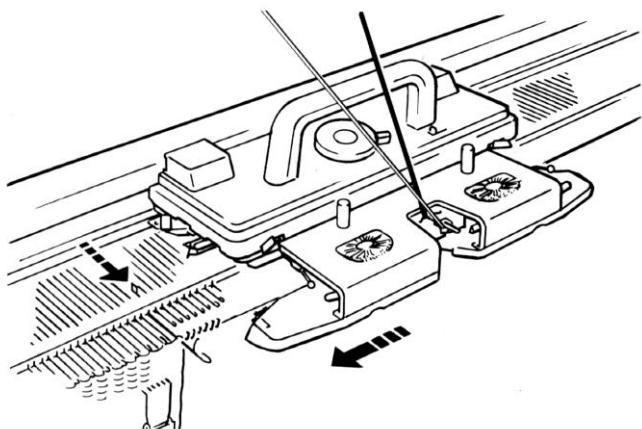
Если кромочные петли провязываются неправильно, выдвиньте крайнюю иглу со стороны каретки в положение D (или в положение C в случае частичного вязания) перед провязыванием каждого следующего ряда.
