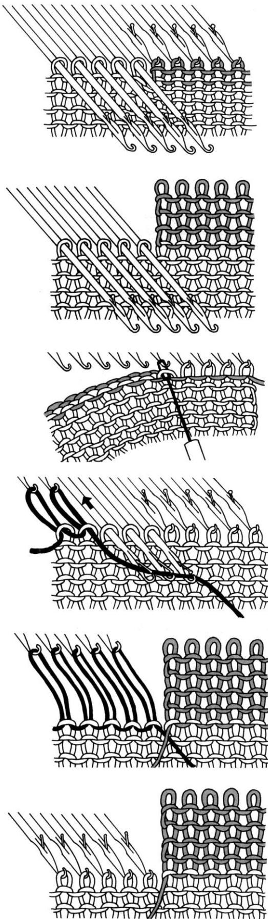
Фиксирование петель с помощью вспомогательной нити I (только для главной каретки). Установите ручку выбора узора в положение O, а иглооттяжные рычаги в положение I.
