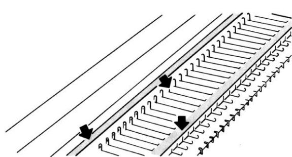
Мягкой, смоченной маслом, тканью протрите пятки игл, рельс и переднюю направляющую игольницы.
