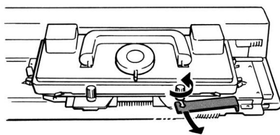
Ослабьте обе гайки на каретке /по стрелке/. Снимите фиксатор и положите его в коробку для принадлежностей.
