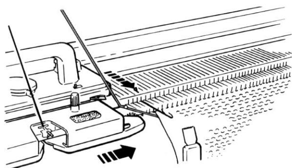
Выдвиньте одну крайнюю иглу со стороны каретки в положение "D" (или "С" при частичном вязании) перед выполнением следующего ряда.
