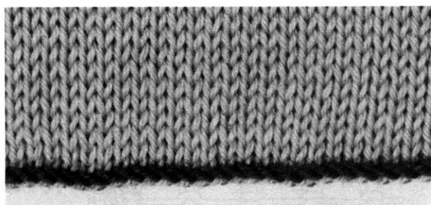
Набор петель на иглу машины способом обкручивания игл рабочей нитью
