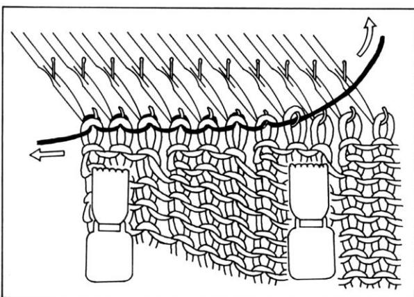
После завершения частичного вязания навесьте грузы, верните петли полотна на крючки игл со стороны, противоположной каретке, потянув за шнур. Все иглы с петлями полотна возвращаются в положение В. Переместите краевой штырек, установив его над двумя крайними иглами в положении В. Если частичное вязание производилось с обеих сторон, свяжите I ряд, затем повторите операцию возвращения петель полотна на иглы машины с другой стороны.
