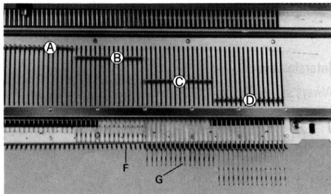
На обоих торцевых концах машины имеются буквы А, В, С и Д. Позиция иглы в игольнице определяется тем, на уровне какой буквы расположена пятка иглы. А - нерабочее положение игл. В - иглы выполняют чулочную вязку и узоры. С -иглы выполняют только чулочную вязку. Д - иглы не вяжут при положении I иглооттяжных рычагов; иглы переходят в позицию В при положении II иглооттяжных рычагов. Числами 0-10 справа и слева от центра (О) маркированы десятки игл.
