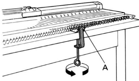
Вставьте струбцины в отверстие “A” в нижней части игольницы.
