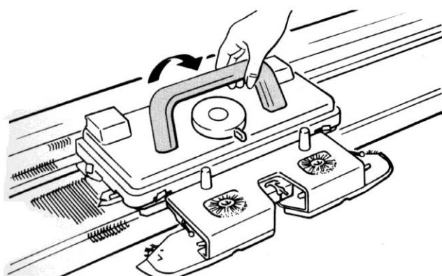
Поднимите ручку каретки в рабочее положение до щелчка.
