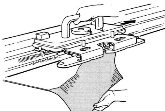
Снимите грузы с полотна.
