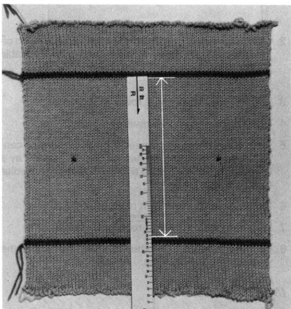
Запишите для памяти значение шкалы регулятора плотности, при котором выполнялся образец.
